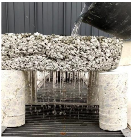
Figura 4: Demostración de una estructura de hormigón permeable filtrando agua. Imagen tomada del documento: “Recomendaciones sobre Pavimentos de Hormigón Permeable” (Spalvier et al., 2021).
